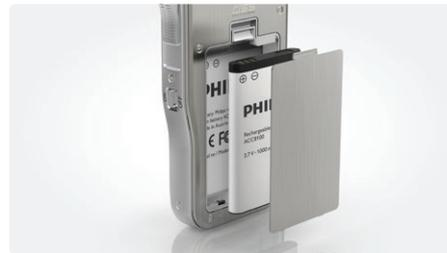
La batería de Li-ion de gran capacidad se puede cargar fácilmente a través de un micro USB estándar. El sensor de luz integrado garantiza un 50% más de duración de la batería con respecto a la competencia. La tecnología inteligente ajusta el brillo de la pantalla, lo que garantiza que la grabadora estará siempre preparada para trabajar con ella.
